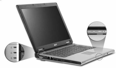
Les indicateurs d'état de l'alimentation, de la batterie et de la communication sans fil sont visibles même lorsque l'écran LCD est fermé.
